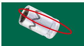
套筒头方孔处有明显的破损打滑,或筒壁有明显的裂痕,表示曾使用在风动工具上。当您在风动作业上使用套筒时,请选择风动系列套筒,其外表一般都是黑色的。
