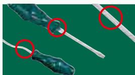
螺丝批手柄破裂或刀杆扭曲显示此螺丝批被敲击或当作撬杆使用。当您作撬开工作时请用适当的撬杆工具。
