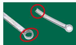
两用扳手弯曲变形或破裂,显示此扳手曾被敲击或当撬杆使用。当您作撬开工作时请用适当的撬杆工具。
