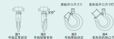
注: 吊钩如出现图4的止索夹弹出的现象应视为已经严重超载使用, 须进行整机报废。
