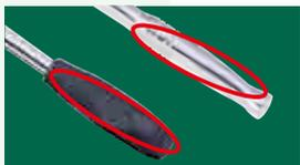
在棘轮扳手手柄上有明显的凹痕或电镀脱落,显示此柄曾被不正常的用锤头敲击或加长手柄(套长管)使用。您应选择较大规格的棘轮扳手来增加扭矩。
